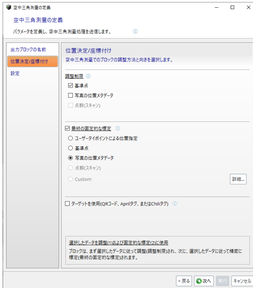
図 41: 空中三角測量の位置決定/位置参照パラメータ
